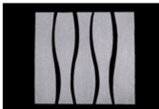
Figura 34: Corte segmentos para se adequarem exatamente à circunferência do tubo. Lembre-se de deixar meia peça inicial / final.
