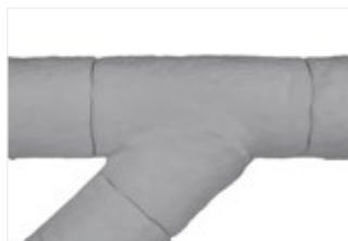
Figura 53: Instale a secção em ângulo oblíquo e fixe no lugar com fio garantindo que todas as juntas estão bem presas sem folgas.
