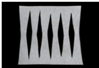
Figura 38: Forme segmentos inversos cortados na forma de losangos na folha de ArmaGel HT.
