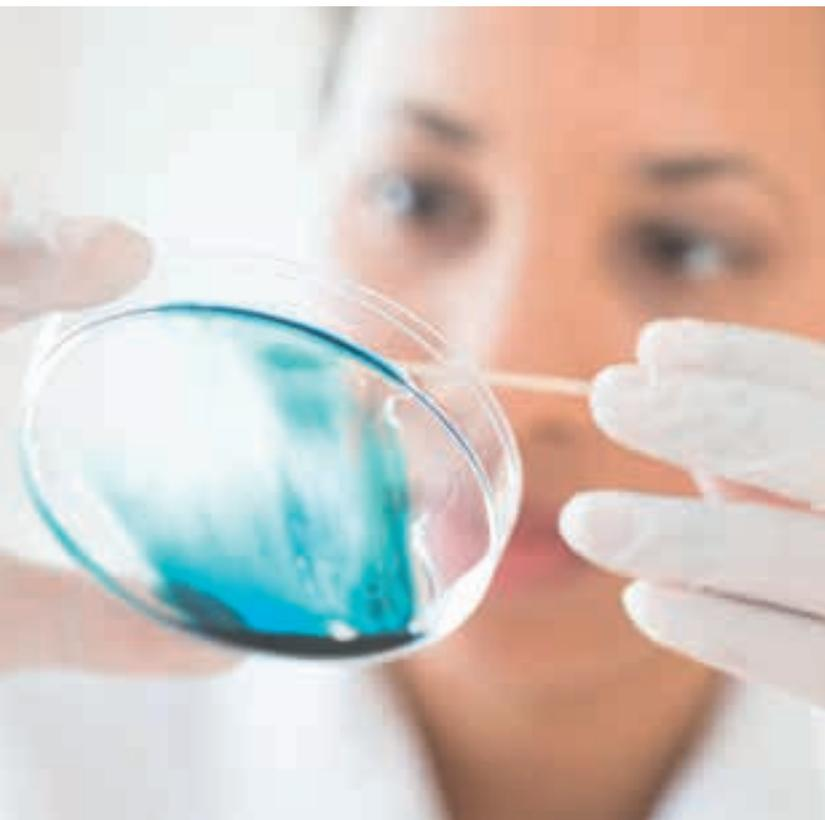
Determinação da resistência a vários fungos, bactérias e leveduras segundo norma ASTM G21/G22.
